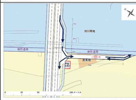
⑤-1 片側スロープ設置
