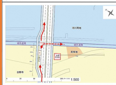
④-1 片側パッカー車エレベーター設置
